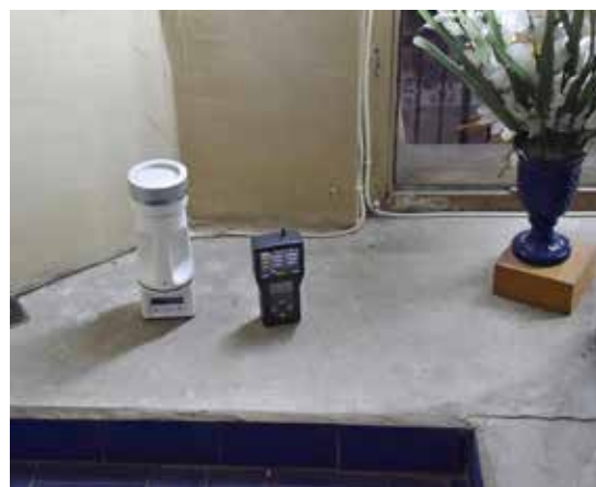
Fig. 1-. Equipos de medición: SAS (izquierda) y Airy Technology (derecha), durante la toma de muestra en la Iglesia de los Santos Juanes.
